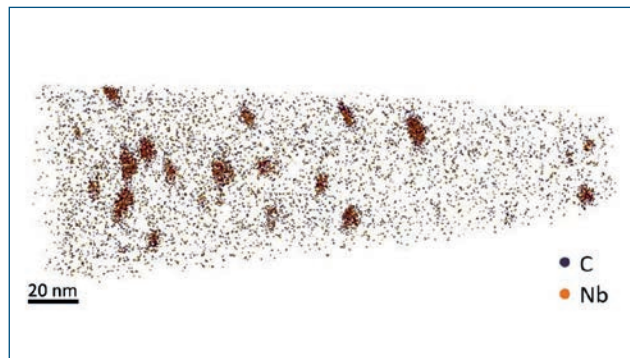
Typische nanometergroße Ausscheidung von Niob zusammen mit Kohlenstoff in einem Niob-mikrolegierten, niedriglegierten Stahl. Typical nanometer-sized precipitation of niobium together with carbon in a niobium-microalloyed low-alloy steel.
