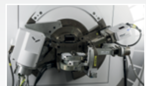
Röntgendiffraktometer PANalytical Empyrean (Innenansicht)
