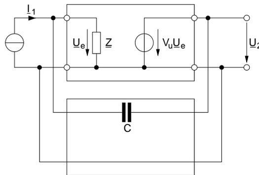
1. Bestimmen Sie die Übertragungsfunktion  $\frac{U_2(s)}{I_1(s)}$  des Verstärkers. (Hinweis: Die Lösung ist besonders einfach mit Hilfe des Miller-Theorems)
