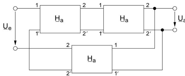
Bestimmen Sie die Übertragungsfunktion  $\frac{U_a}{U_e} = \underline{H}_3$  des rückgekoppelten Verstärkers. Analysieren Sie die Stabilität des Verstärkers mit Hilfe des Nyquist-Kriteriums und der Darstellung der Schleifenverstärkung im Bode-Diagramm. Wie groß darf  $v_u$  maximal sein, damit der Verstärker stabil ist?
