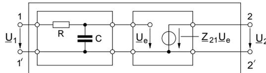
Bestimmen Sie die Übertragungsfunktion  $\frac{U_2(s)}{U_1(s)} = \underline{H}_a$  des Verstärkers unter der Annahme  $\underline{Z}_{21} = v_u \in \mathbb{R}$ . Zeichnen Sie das zugehörige Bode-Diagramm von  $\underline{H}_a(j\omega)$  für Betrag und Phase.
