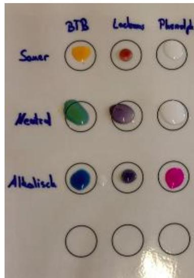
Abbildung 17: Präparierte Tüpfelplatte mit DREI Indikatoren (Bromthymolblau, Lackmus, Phenolphthalein)
