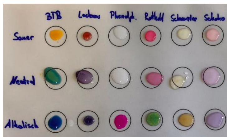
Abbildung 18: Präparierte Tüpfelplatte mit ALLEN Indikatoren
